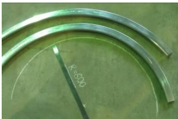
Рис. 4. Гнутые профили для шпангоутов с продольной кривизной полученные при гибке-прокатке на станке ГПС.
