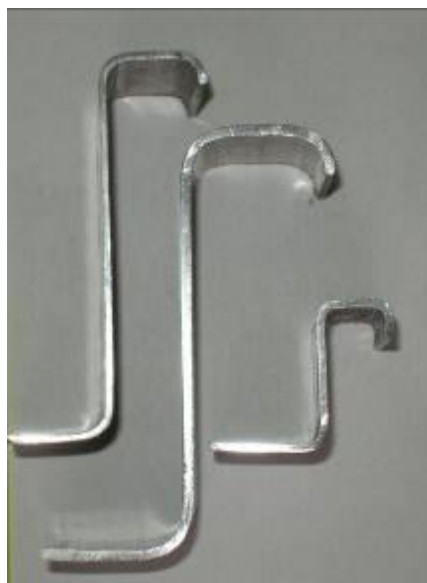
Рис. 2. Z образные гнутые профили из алюминиевых сплавов для изготовления шпангоутов и стрингеров самолета.
